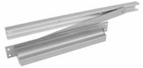
0098.480116 Deurdranger inbouw met glijarm, DR116, 260 x 59 x 37 mm, sluitkracht 2-5.
