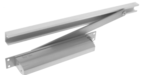
0098.480118 Deurdranger inbouw met glijarm, DR118, 215 x 54 x 32 mm, sluitkracht 2-4. Geschikt voor rook / brandwerende deuren.
