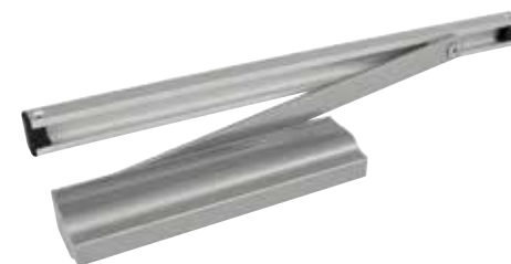
0098.480113 Deurdranger met glijarm, DR113, 236 x 59 x 37 mm met sluitvertraging en openingsdemping, sluitkracht 2-4. Geschikt voor rook / brandwerende deuren.
